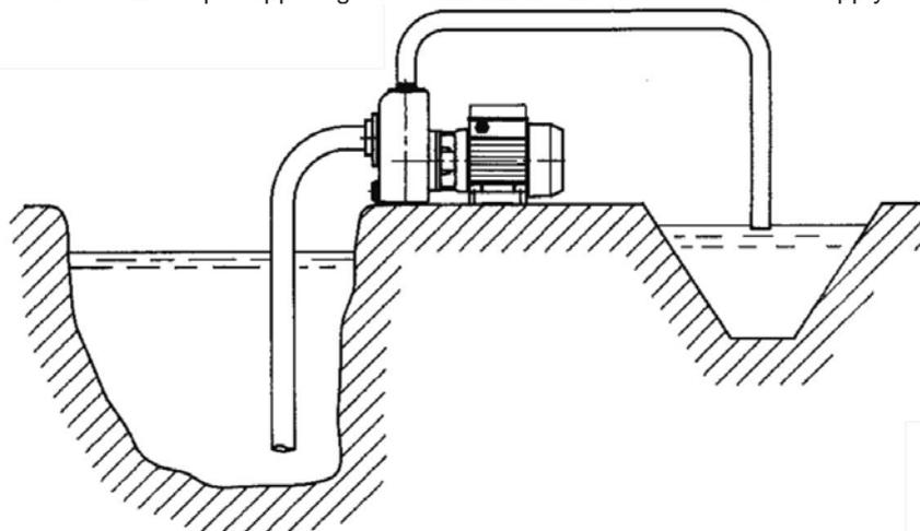
Installazione per travaso a scorrimento / Installation for running transfer
