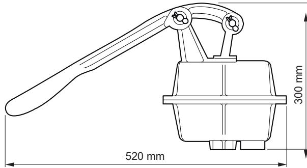
**Collocata su una pompa centrifuga ne permette l'adescamento in pochi istanti; è sufficiente azionare manualmente la leva per consentire l'evacuazione dell'aria dalla tubazione di aspirazione ed il successivo riempimento della pompa con il liquido da pompate. Questa soluzione, semplice, economica e senza alcun bisogno di manutenzione, risolve il problema dell'adescamento ed elimina la fastidiosa operazione di riempimento manuale.**
